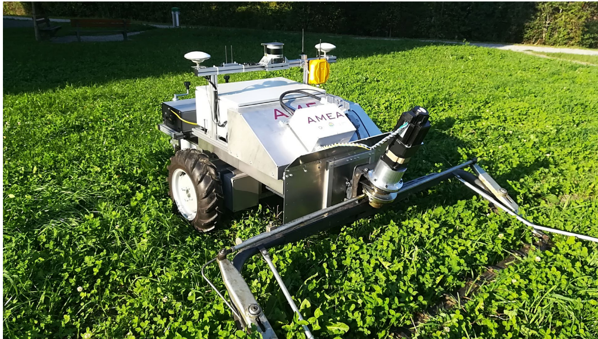
Elektrifizierter Mähbalken (ohne Sensorik)
